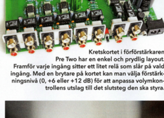
Kretskortet i förstärkaren Pre Two har en enkel och prydlig layout. Framför varje ingång sitter ett litet relä som slår på vald ingång. Med en brytare på kortet kan man välja förstärkningsnivå (0, +6 eller +12 dB) för att anpassa volymkontrollens utslag till det slutsteg den ska styra.
