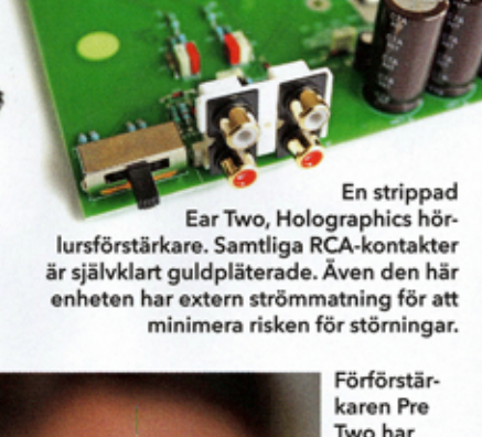
En strippad Ear Two, Holographic Audios hörlursförstärkare. Samtliga RCA-kontakter är självklart guldpläterade. Även den här enheten har extern strömmätning för att minimera risken för störningar.
